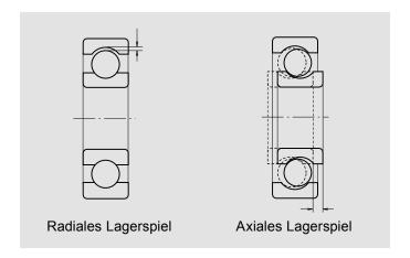
Die Lagerluft beeinflusst in hohem Maße die Leistungsfähigkeit von Wälzlagern im Betrieb. Hierzu gehören u.a. Lebensdauer, Vibration, Geräuschpegel und die Wärmeentwicklung.
