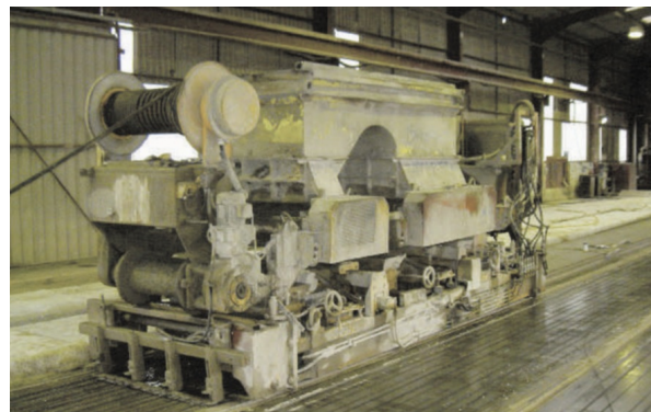
↑ Produktionsanlage für Betondecken
